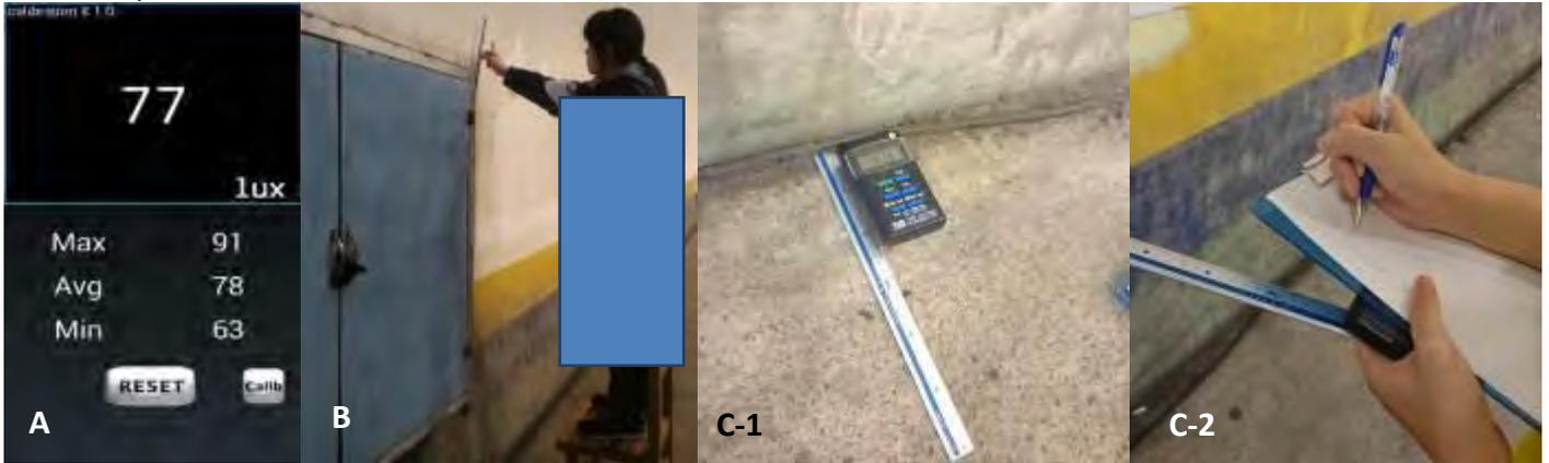
圖 3、照度及電波測量之方法。A 使用 Lux Meter 測量環境照度；B 測量蜘蛛網離地高度；C 高斯計測試完後再記錄。
