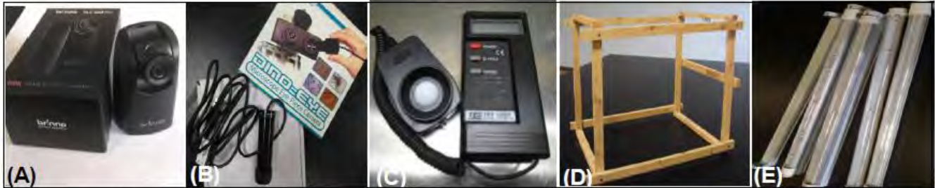
圖一 實驗設備與器材 (A)縮時攝影相機 (B)數位式電子目鏡 (C)數位式照度計 (D)自製木架的「觀察實驗屋」(E)LED 燈管(白光、紅光、綠光、藍光和專用燈台)。
