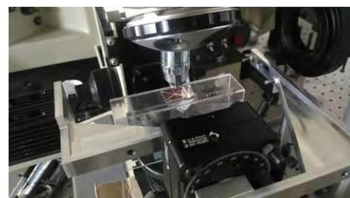
圖 3. 以 718 雷射光激發 Au NPs 的 SPR 之實驗架設示意圖。雷射光從樣品上方入射，穿過川七分子後進入 Au NPs。
