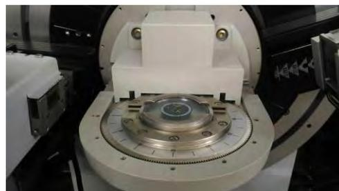
圖 1. 右圖為 X 光繞射實驗架設示意圖，實驗以反射式配合掠角入射進行。左圖顯示川七純化 IAA 粉末直接放置在 X 光機上，進行實驗。
