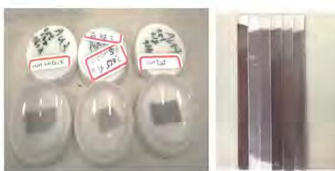
圖21. 用以產生表面電漿共振，附著在玻片上的金奈米微粒。金奈米微粒係以熱蒸鍍法直接蒸鍍在玻片上。
