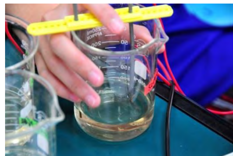
圖 19b 銅線電極置入土壤取出液中
