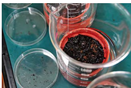
圖 18a 浸於 3%人工海水模擬土壤鹽化
