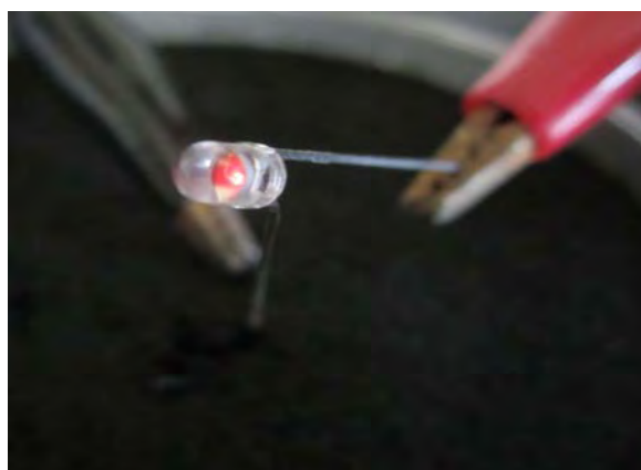
圖 16 以 LED 檢測其導電性
