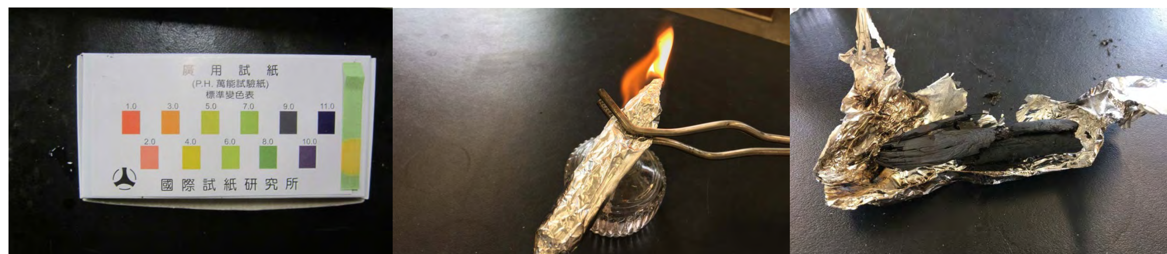
圖29乾餾的液體為酸性 圖30乾餾的氣體具有可燃性 圖31乾餾的固體產物為碳
