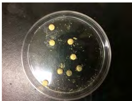
圖 46 茭白筍殼和碳由打錠機製成的貓砂
