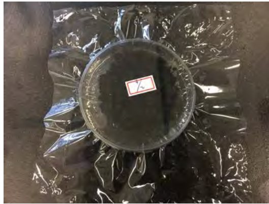
圖 9 茭白筍殼碳吸水實驗裝置
