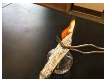
圖 39 乾餾出的氣體具有可燃性
