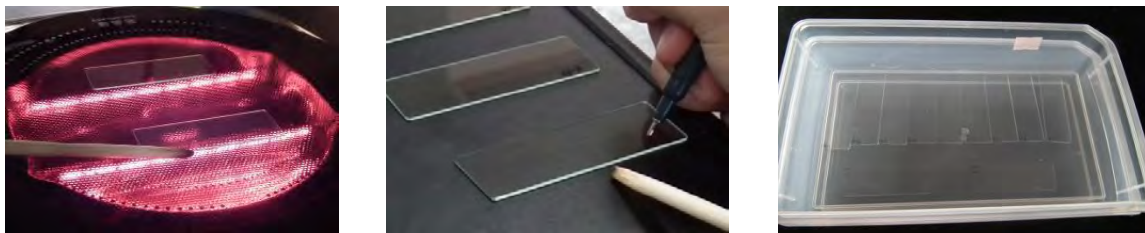
圖六、利用電晶爐將載玻片加熱，並編號，放在盒子中加蓋蓋好
