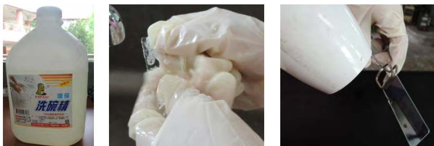
圖十五、將載玻片以洗碗精搓揉，再以蒸餾水沖洗，最後以吹風機冷風吹乾
