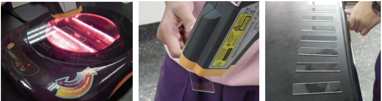
圖六、利用電晶爐不同時間將載玻片加熱，並測量溫度，放置冷卻到室溫
