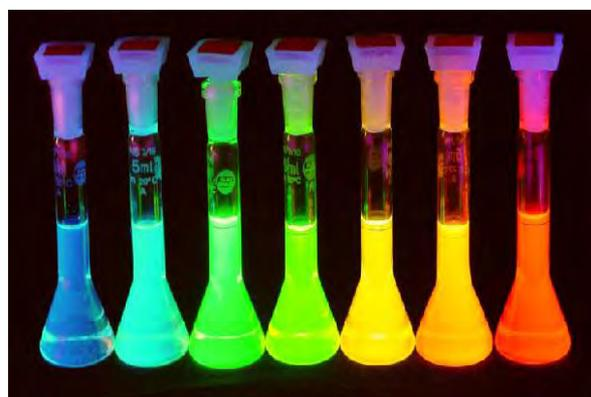
圖二 不同尺寸的硒化鎘(CdSe)量子點在紫外線的照射下發出螢光<sup>[3]</sup>
