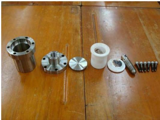
圖三 高壓釜的組成元件
