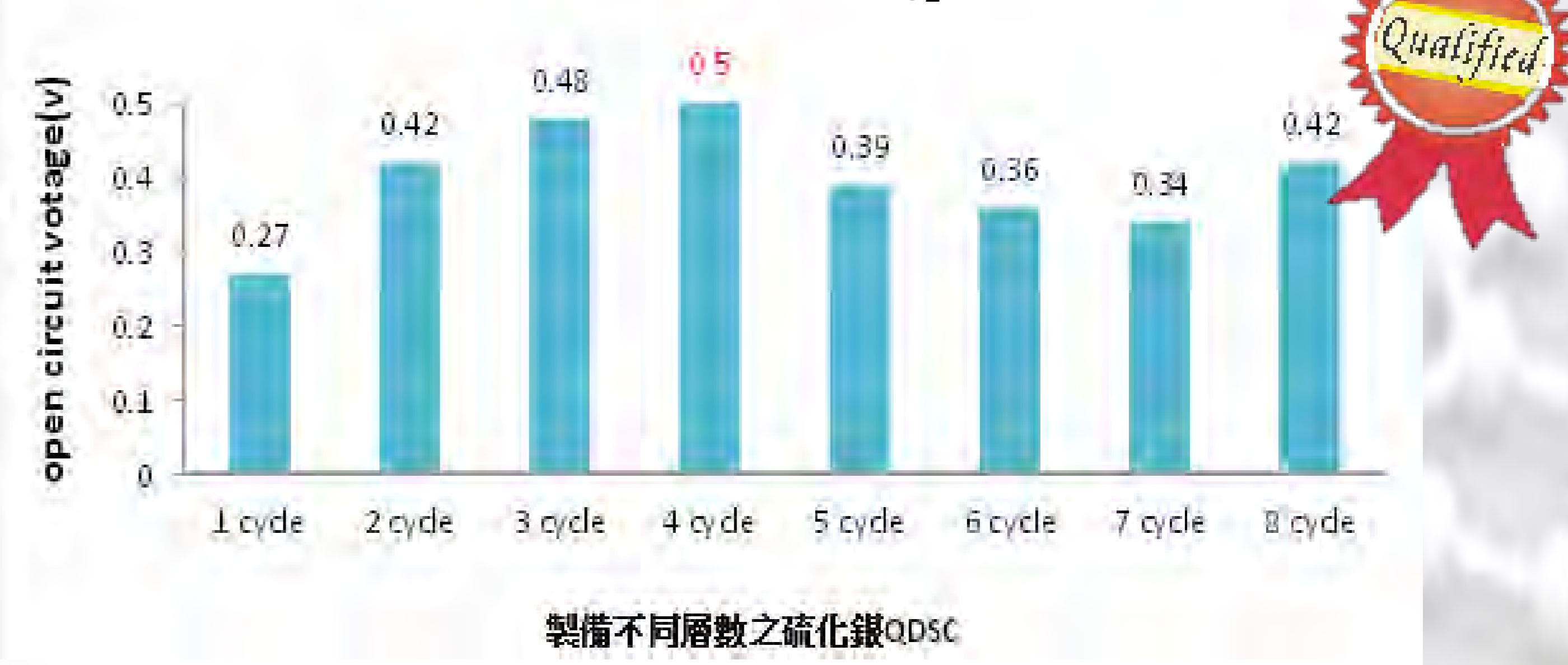
圖二、1M硝酸銀+0.5M硫化鈉，沉積不同層數Ag 2 S QDSC之開路電壓圖
