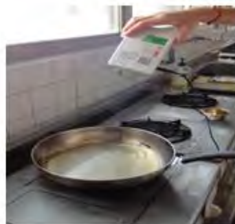
圖(二十三) 量測油在平底鍋中發煙後 PM 2.5
