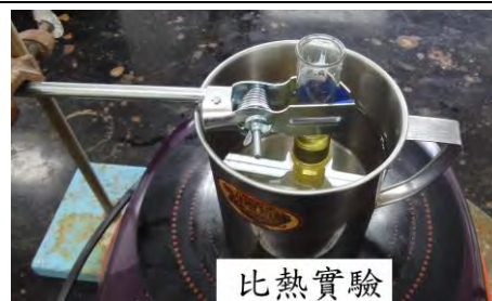
圖(六) 食用油脂比熱實驗裝置圖
