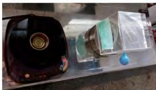
圖(二十五) 口罩降低 PM_{2.5} 實驗裝置
