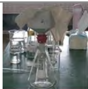
圖 3-1 豆漿布裹著布赫納漏斗後塞入吸濾瓶口
