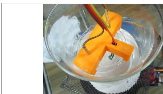
圖 5-1-1 自製電阻溫度感測裝置實驗裝置圖
