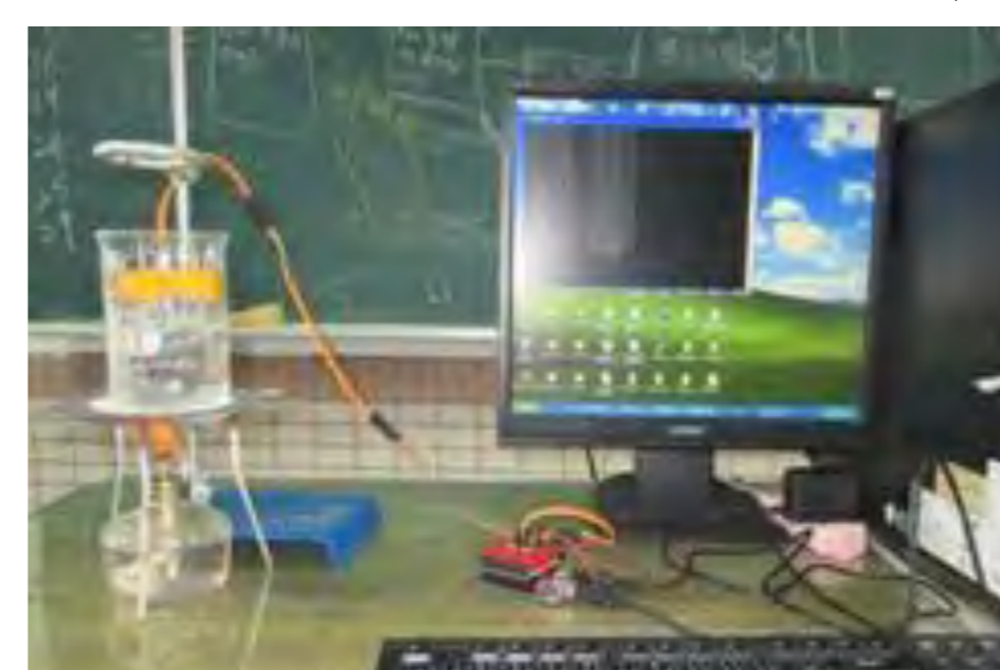
自製測量電阻溫度記錄裝置
