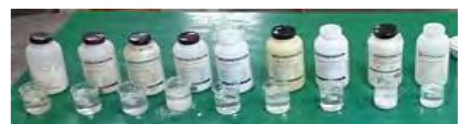
圖1-2-1 含Cl - 及SO 4 2- 飽和溶液對豆漿的凝結情形。
