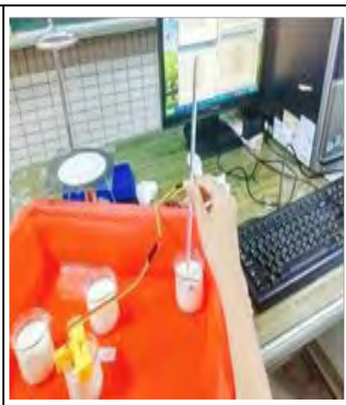
圖 1-1-4 利用熱平衡使四杯不同豆漿同溫度
