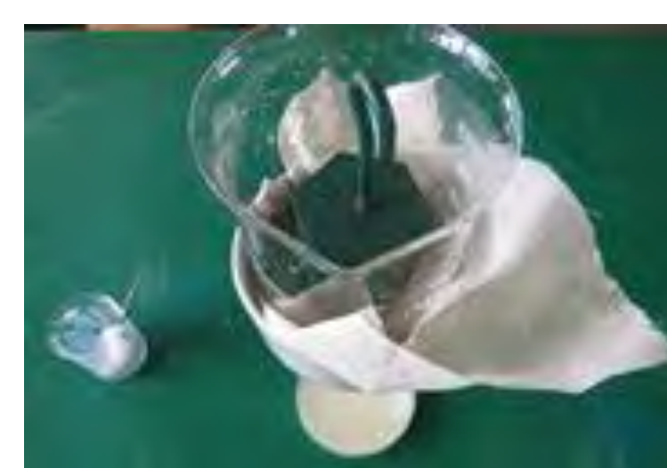
圖3-1-2 重1kg物置於上方壓住下方吸濾瓶可收集乳清
