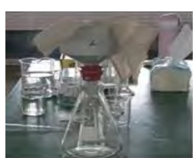
圖3-1-1 豆漿布裹著布赫納漏斗後塞入吸濾瓶口
