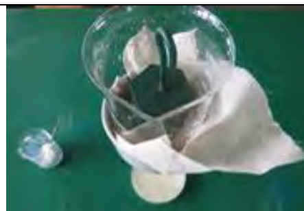
圖 3-2 1kg 重物置於上方壓住，下方吸濾瓶可收集乳清
