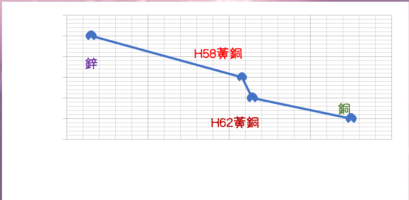
圖8 合金推測功函數對電弧最大距離關係圖
