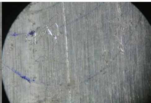
圖三十九、石頭輔助蝕刻鋁的效果
