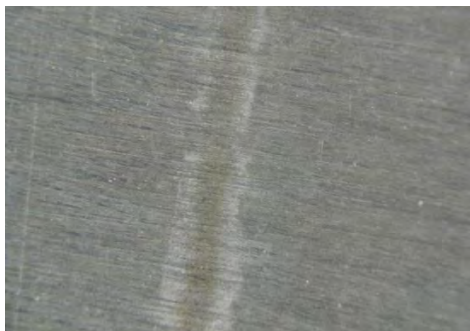
圖三十八、石頭輔助蝕刻鐵的效果
