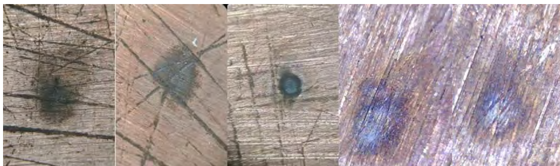
圖二十六、第二代電漿蝕刻裝置不同蝕刻痕跡的比較(差異大，不具有一致性)
