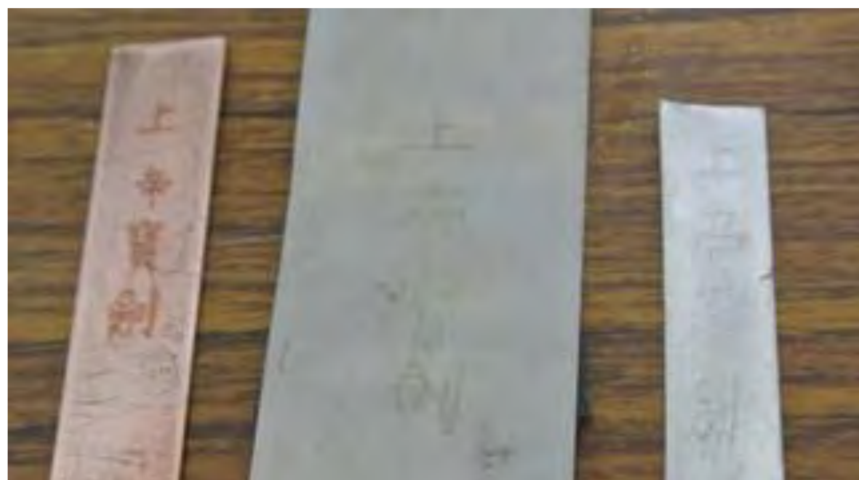
圖四十四、在銅、鋁、鐵片上用電漿蝕刻刻出字
