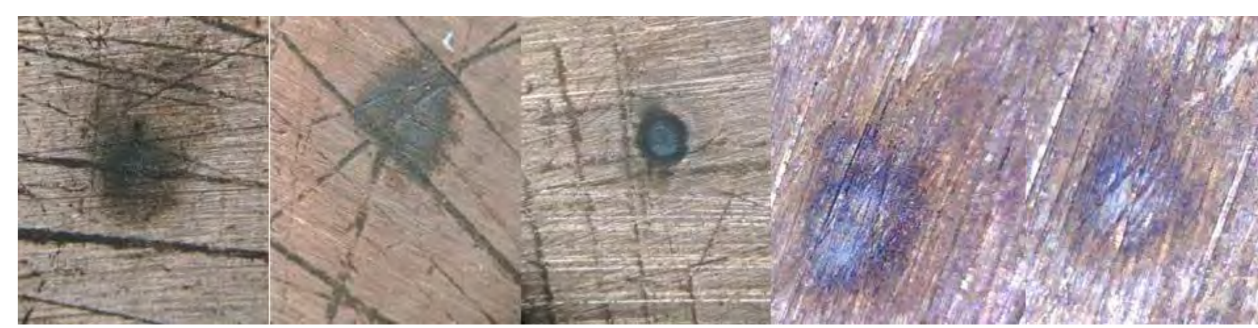
圖三十八、第二代電漿蝕刻裝置蝕刻痕跡
