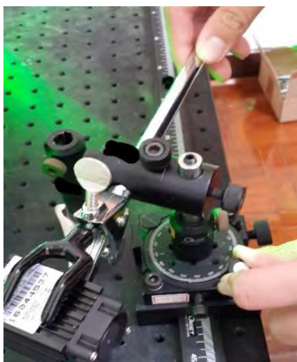
圖 4-3：角度旋轉移動平台
