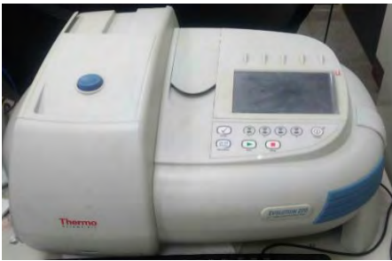
圖 3-1：UV-VIS 穿透吸收光譜儀
