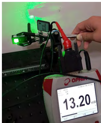
圖 4-4：光偵測器的固定
