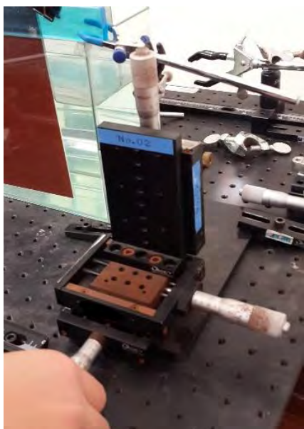
圖 4-1：XYZ 三軸精密移動平台
