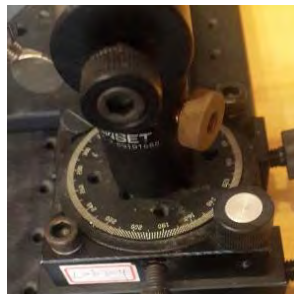
圖 3-2：角度旋轉移動平台
