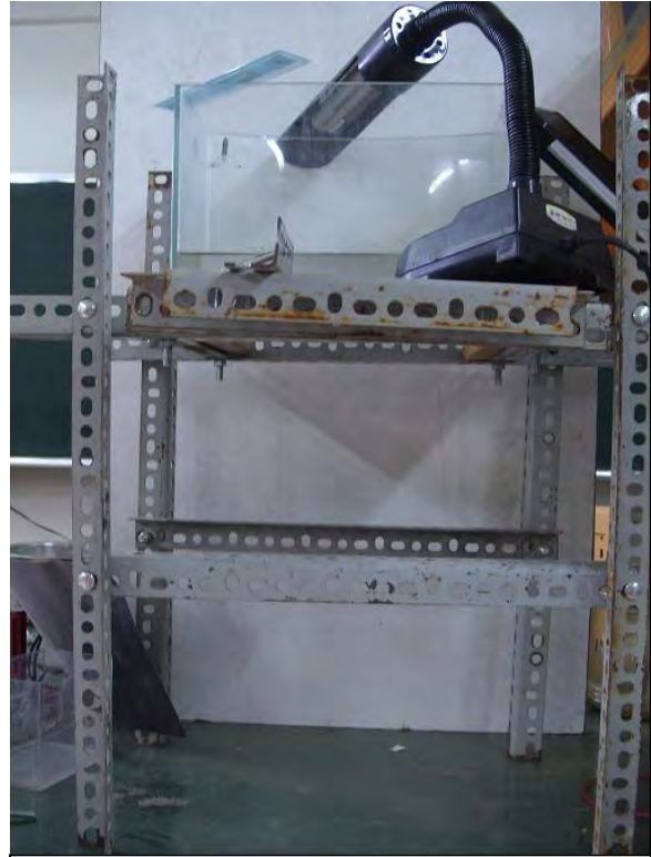
圖 3-3 利用角鋼將魚缸架起來，可以方便進行實驗觀察及攝影。
