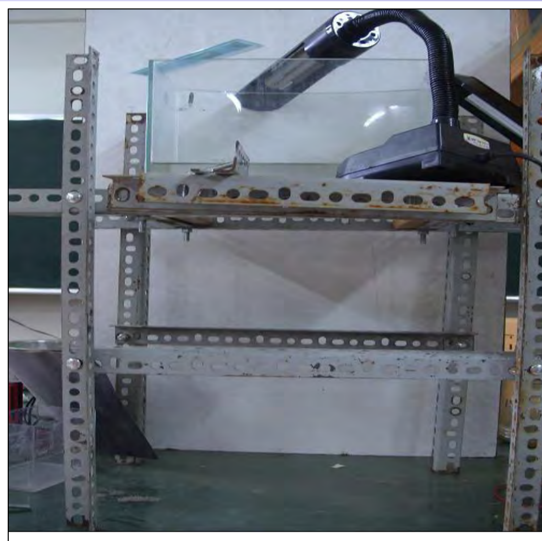
圖二、利用角鋼將魚缸架起來，可以方便進行實驗觀察及攝影。
