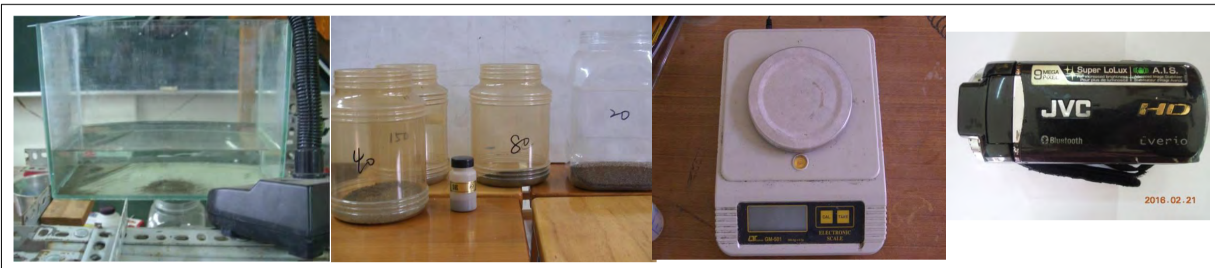
圖一、透明魚缸、不同顆粒大小的沙子、電子秤、錄影機。
