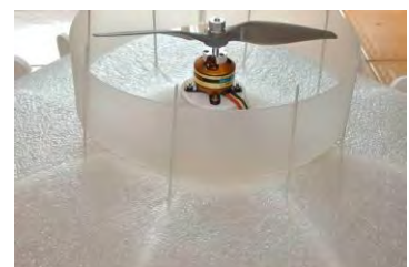
風罩底部出風口高度 3.5cm
