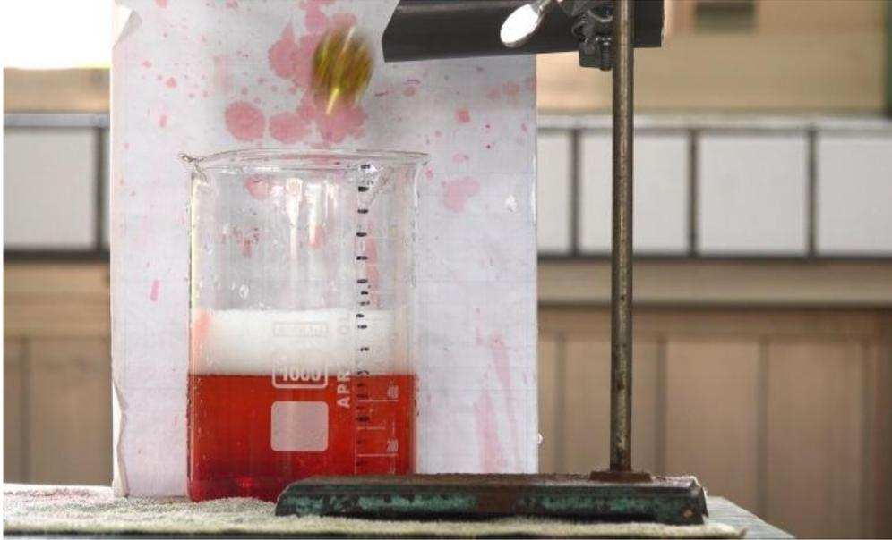
圖十九 測量不同泡沫厚度對水花濺起高度之裝置圖
