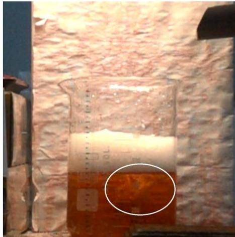
圖五十一—球落下時把泡沫帶到水裡照片
