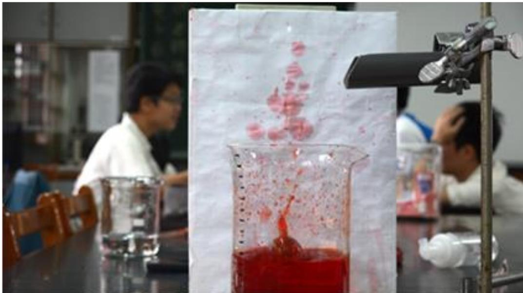
圖二十三 測量不同距水高度對水花濺起高度之裝置圖
