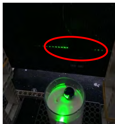
圖七(2) 彈珠落下,遮蔽雷射光點
