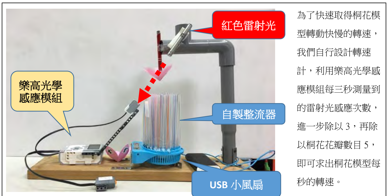
圖六、自製雷射光與樂高光學感應模組之裝置
