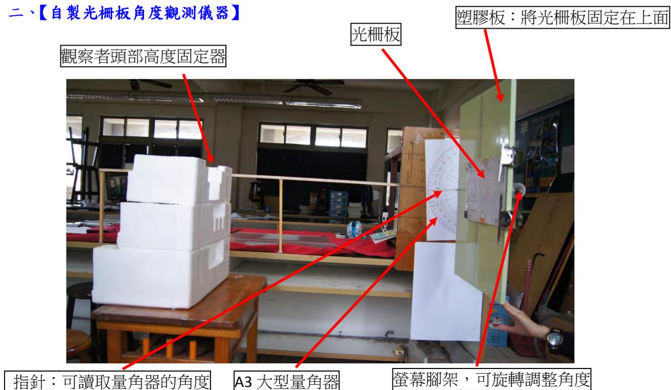
圖 1、自製光柵板角度觀測儀器。
