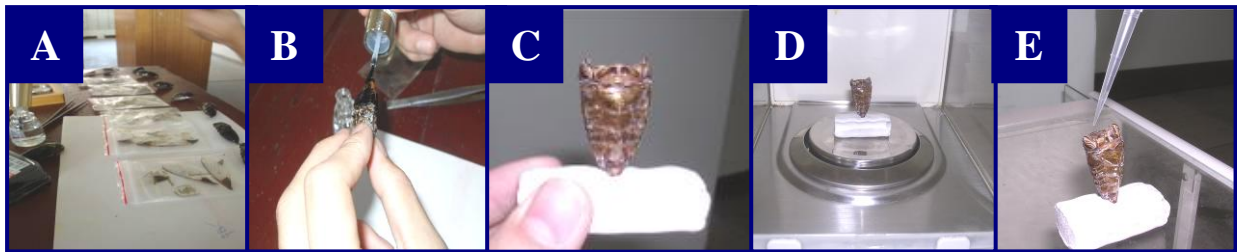
圖 6、共鳴腔體積的測量方法與步驟 A~E。
