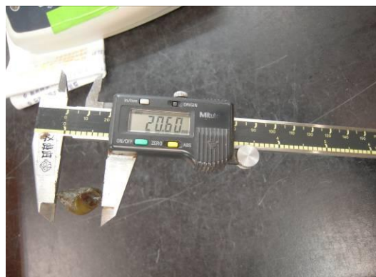
圖(五)電子游標尺測量殼長
