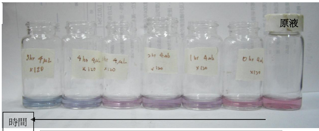
圖三十二、Au 膠體溶液+鱈魚(室溫) 依時間之顏色變化
