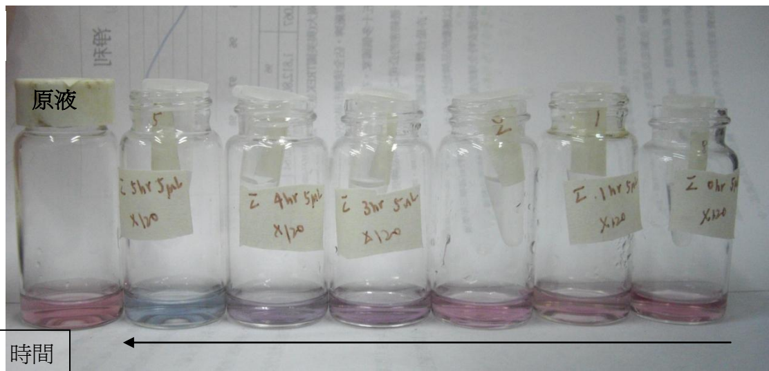
圖三十五、Au 膠體溶液+鱈魚(冰) 依時間之顏色變化
