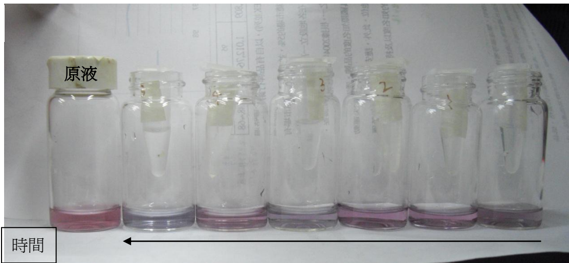
圖三十四、Au 膠體溶液+鱈魚(室溫) 依時間之顏色變化
