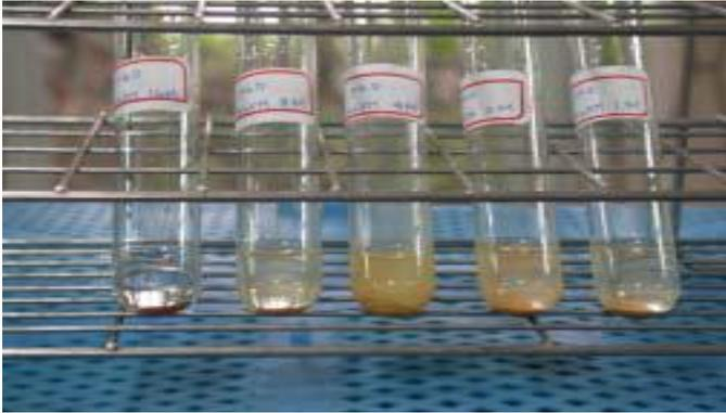
圖. 12 不同 NaOH<sub>(aq)</sub> 濃度下，產生紅色沉澱物的情形
