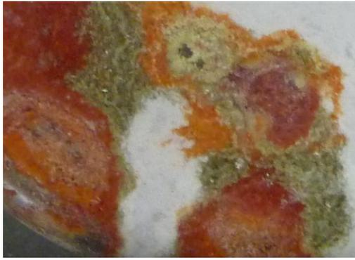
圖. 47  $\text{Pb}(\text{CH}_3\text{COO})_2$  在非水溶劑( $\text{CH}_3\text{OH}$ )、固體的  $\text{NaOH}_{(s)}$  下，顏色由白、綠、黃、紅、**紫**，層次分明的變化。
