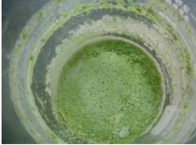
圖. 34  $x\text{PbO}\cdot y\text{H}_2\text{O}$  綠色物
