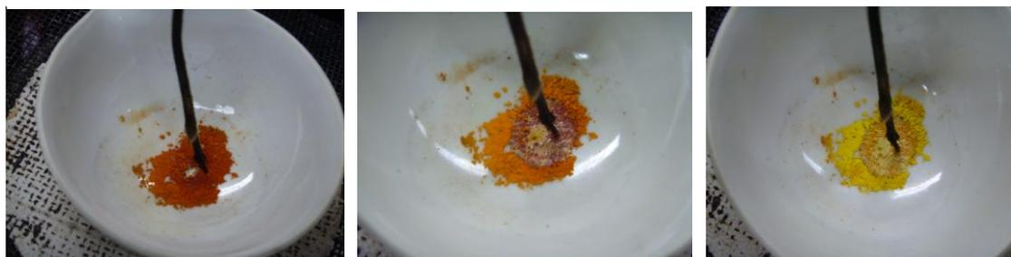
圖. 11  $\alpha$ -PbO 轉化為  $\beta$ -PbO 變色過程
