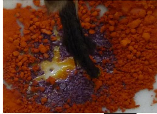
圖. 48  $\alpha\text{-PbO}$  轉化為  $\beta\text{-PbO}$  變色過程
