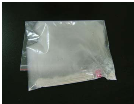
圖二：電石與水產生乙炔 (靜置待其反應完成及降溫)
