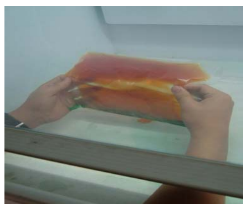
圖五：銅片與濃硝酸產生紅棕色二氧化氮(搖晃使其反應均勻)
