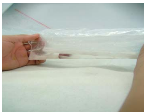
圖一：電石與水產生乙炔 (搖晃使其反應均勻)
