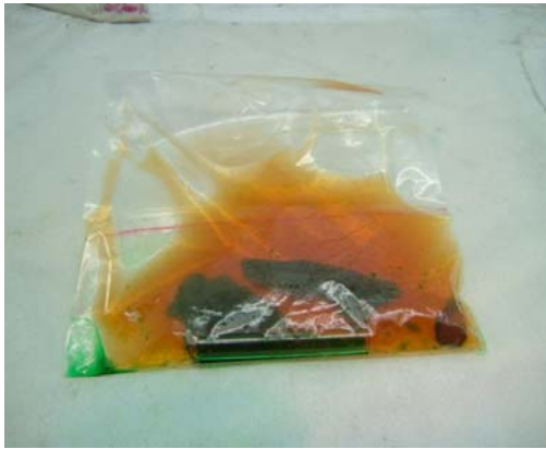
圖六：銅片與濃硝酸產生紅棕色二氧化氮(靜置待其反應完成及降溫) 圖七：排空袋內生成之二氧化氮
