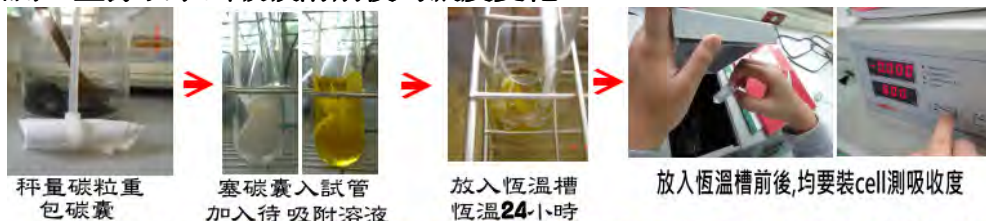
圖九：以分光光度計偵測，碳吸附前後，有色離子濃度變化之實驗步驟流程
